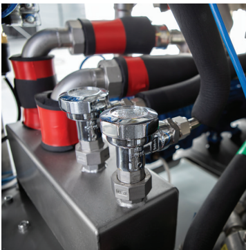
Все трубы и соединительные узлы изготовлены из нержавеющей стали марки AISI 304 и AISI 316.
